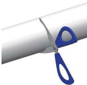
Cortar el manguito según la longitud de la tira
