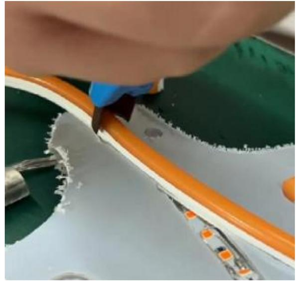
4. Encajar en el tubo de silicona, cortar el tubo correctamente
